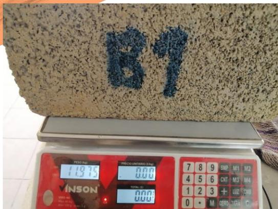
El peso volumétrico seco de los especímenes de los diferentes lotes en estudio se muestra en la tabla 3. La gráfica de la figura 9 muestra que ningún espécimen cumple con lo que indica la normativa, ya que se encuentran por debajo del valor mínimo de 1700 kg/m<sup>3</sup>.
