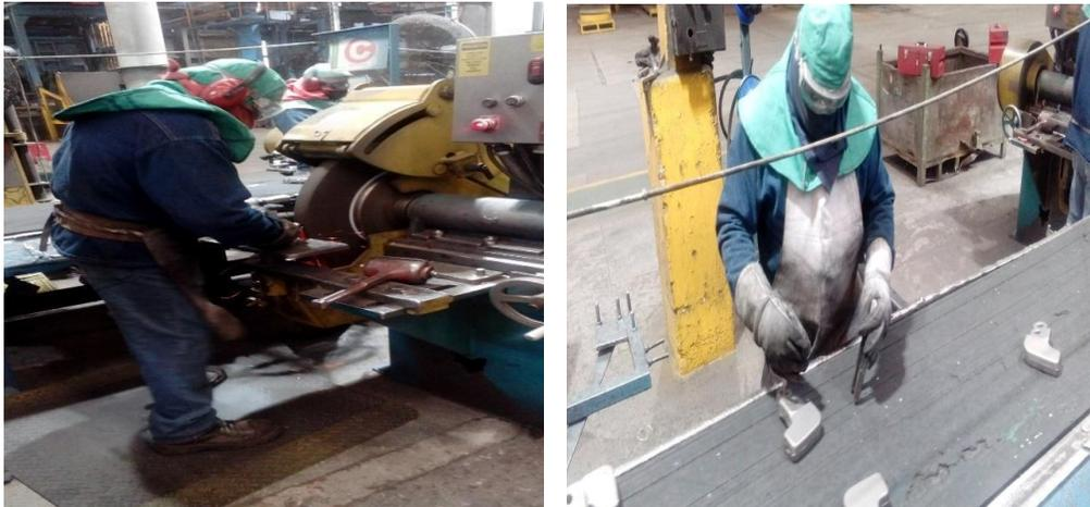
**ETAPA 3.** Muestra de partes de producción. El departamento de calidad revisa por procedimiento que las piezas cumplan con los parámetros dimensionales, por lo que las muestras son enviadas al laboratorio para un estudio de cromo y dureza. En la figura 5 se puede observar el registro de producción y el muestreo enviado al laboratorio.
