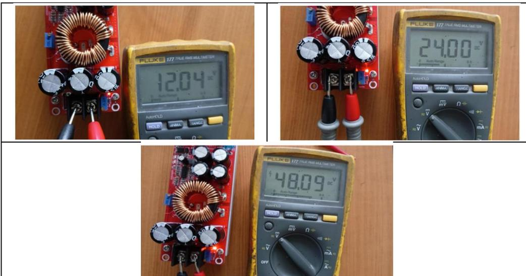
Figura 7 Salidas de 12, 24 y 48 Volts CD.
